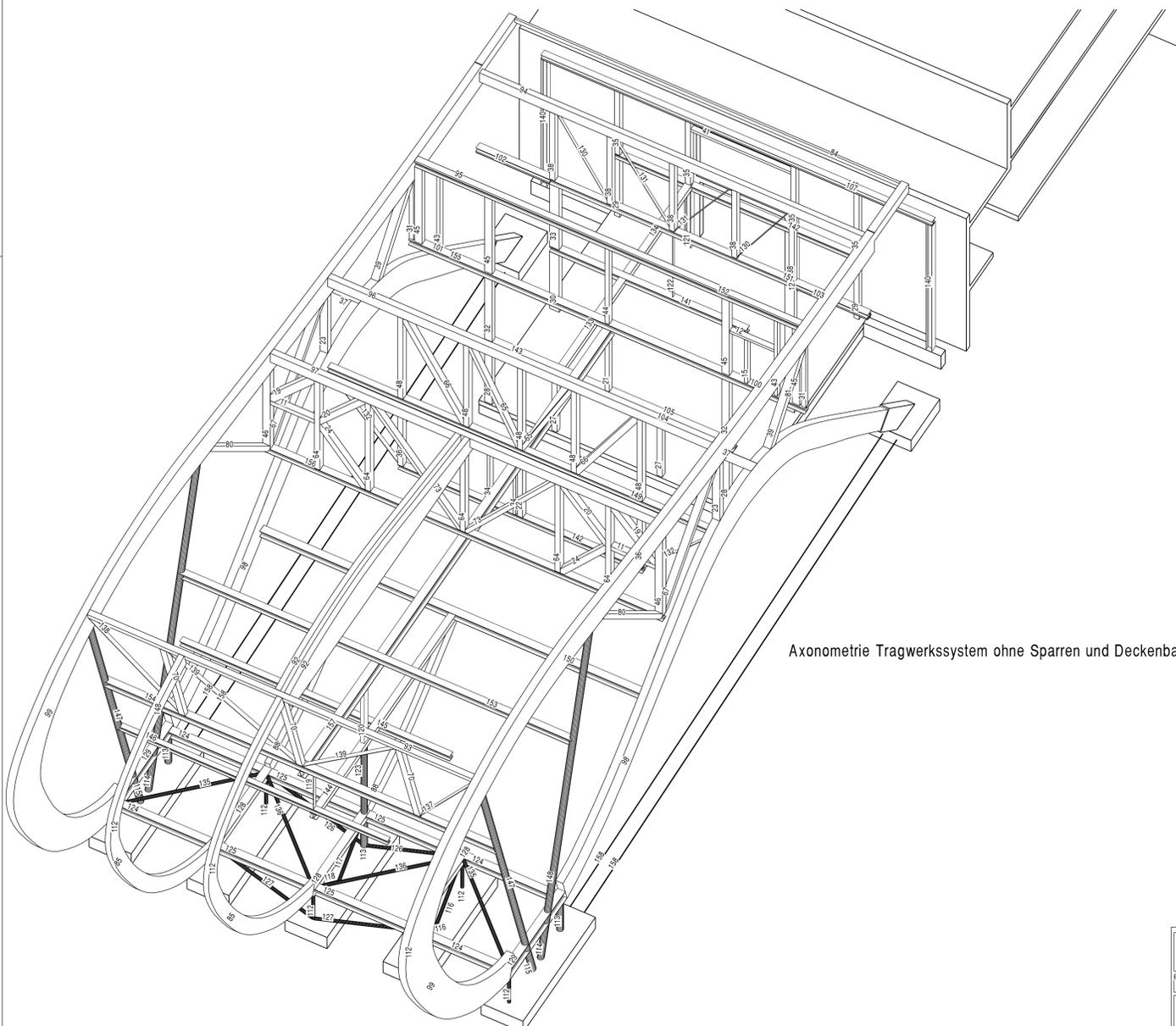
Axonometrie Tragwerkssystem ohne Sparren und Deckenbalken/Stege
